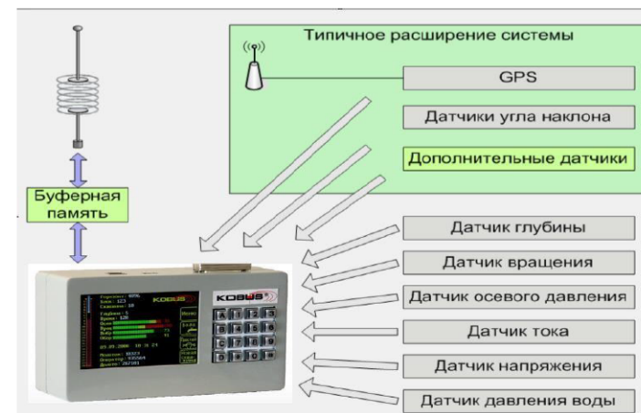
Рисунок 1 – Прибор КОБУС – оперативный сбор данных с буровых станков
